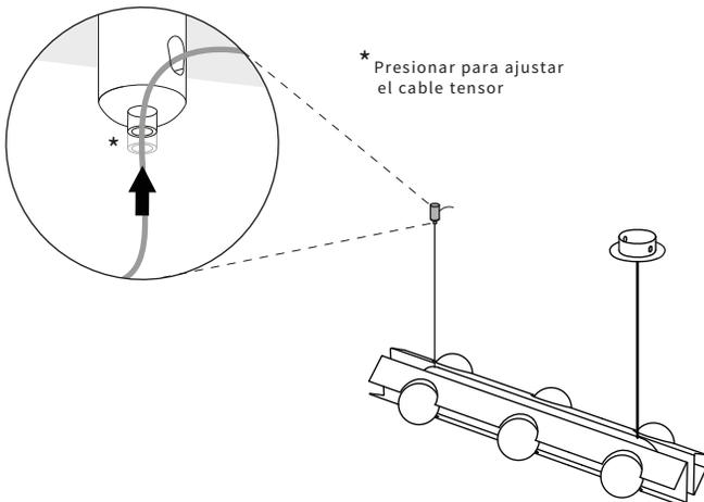
\* Presionar para ajustar el cable tensor
