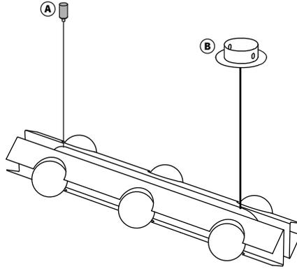
**1** Colocación de taquetes. Antes de barrenar marcar la ubicación de los tornillos de acuerdo a la **Plantilla de Fijación** y asegurar que queden alineados correctamente.
