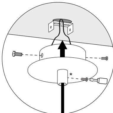
**3** Conexión de cables + con + y - con - a través del conector.
