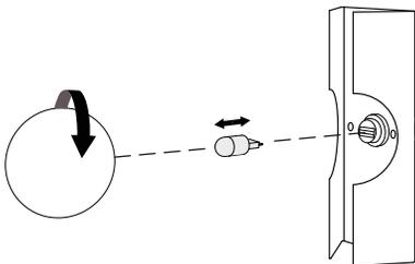
**1** Colocación de taquetes. Antes de barrenar marcar la ubicación de los tornillos de acuerdo a la **Plantilla de Fijación** y asegurar que queden a nivel de manera horizontal.
