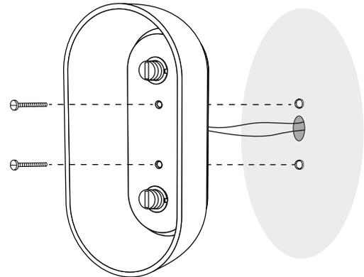
**4** Colocación de tapa de latón, focos y difusores.
