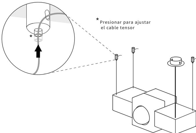
**5** <sup>A</sup> Cortar excedente de cable tensor, hasta haber realizado la conexión eléctrica.
