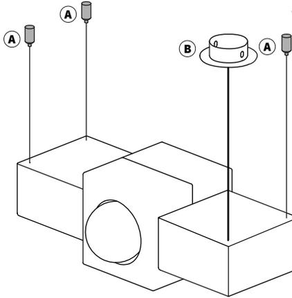
**1** Colocación de taquetes. Antes de barrenar marcar la ubicación de los tornillos de acuerdo a la **Plantilla de Fijación** y asegurar que queden alineados correctamente.
