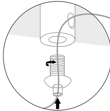
**4** <sup>A</sup> Nivelar la luminaria y ajustar a la altura requerida.
