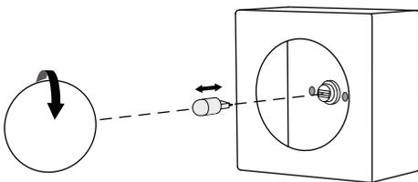
**1** Colocación de taquetes. Antes de barrenar marcar la ubicación de los tornillos de acuerdo a la **Plantilla de Fijación** y asegurar que queden a nivel de manera horizontal.
