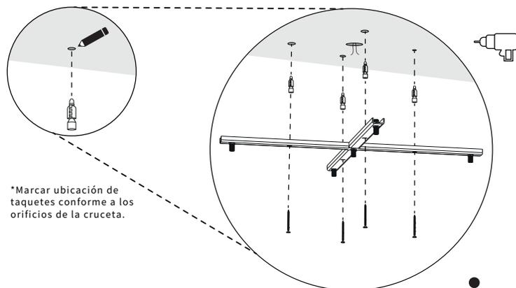
\*Marcar ubicación de taquetes conforme a los orificios de la cruceta.
