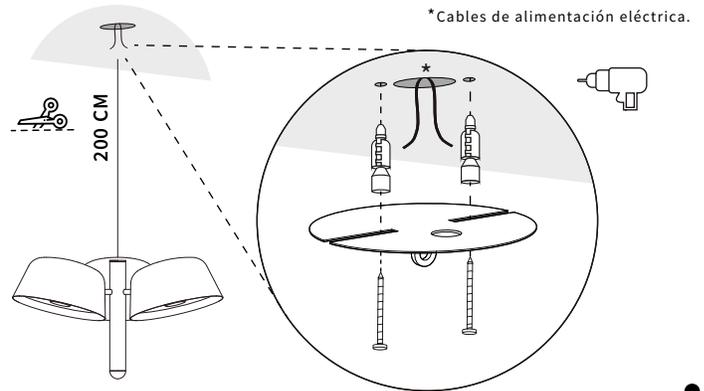
**2** Pasar fijador, canope y sujetador "8" a través del cable.
