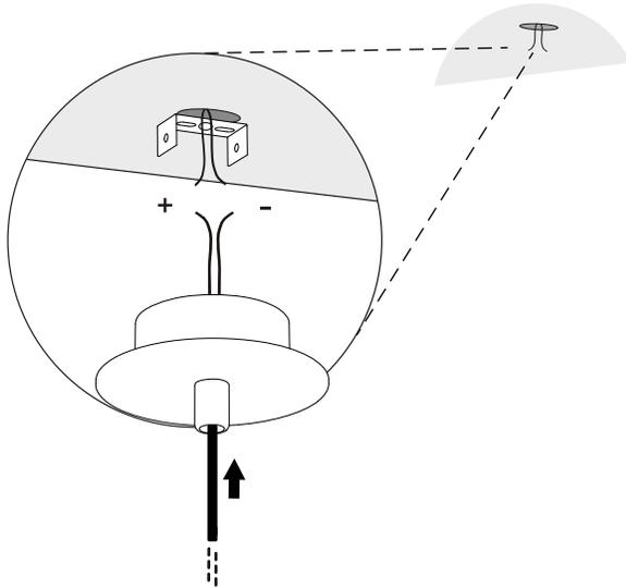
**3** Conexión de cables + con + y - con - a través del conector.
