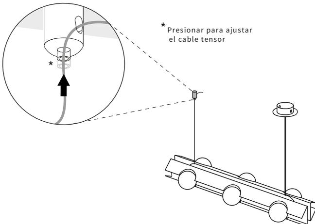
**5<sup>A</sup>** Cortar excedente de cable tensor, hasta haber realizado la conexión eléctrica.
