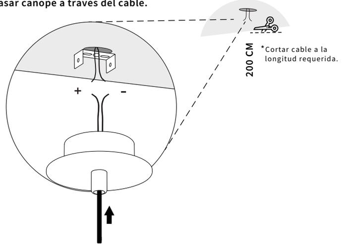
**4** Conexión de cables + con + y - con - a través del conector.
