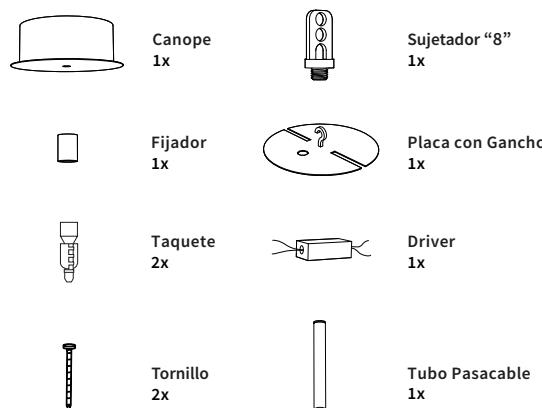
**2** Pasar tubo pasacable, fijador, canope y sujetador "8" a través del cable.
