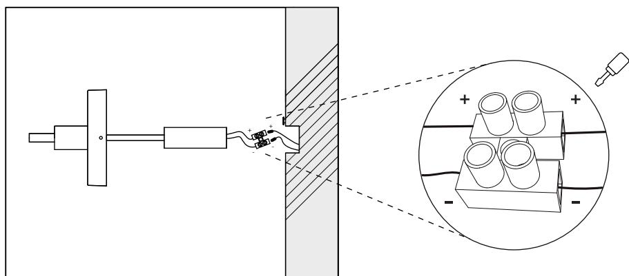
\*Dejar una separación de 2-3 mm del muro.
