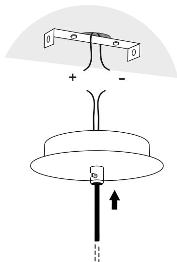
**3** Conexión de cables + con + y - con - va través del conector.
