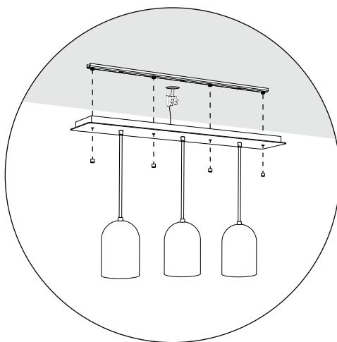
\* Nivelar y ajustar el canope de acuerdo a la superficie del plafón ajustando las tapas ciegas.
