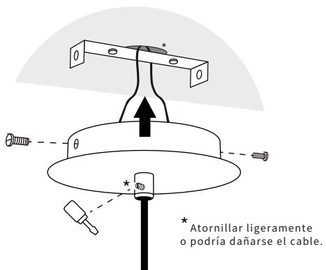
**1** Cortar el cable a longitud deseada. Fijación de grapa de sujeción.
