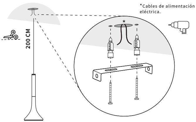
**3** Conexión de cables + con + y - con - a través del conector.
