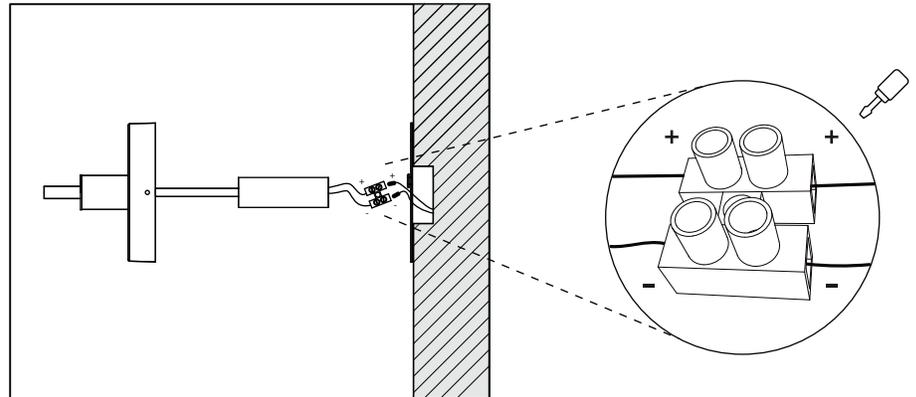
**4** Sujetar módulo LED a pijas hexagonales.
