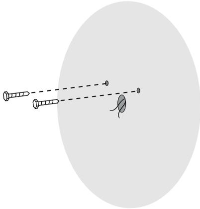
\*Dejar una separación de 2-3 mm del muro.
