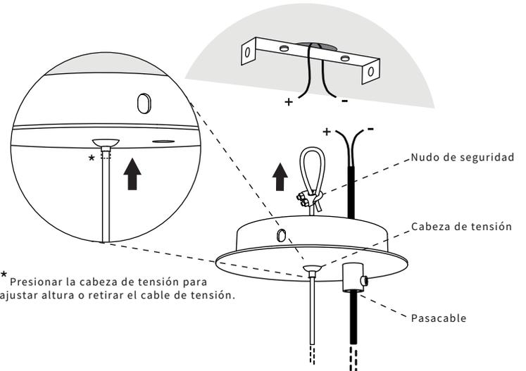
\* Presionar la cabeza de tensión para ajustar altura o retirar el cable de tensión.
