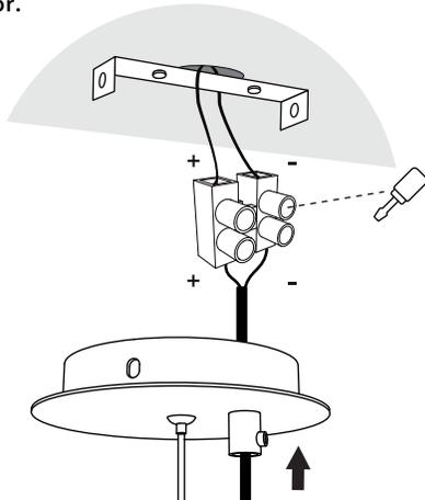
**2** Pasar el cable de electricidad por el pasacable y el cable de tensión por la cabeza de tensión. Colocar nudo de seguridad en el cable de tensión.
