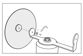
\*Colocar rondana entre el tornillo y la grapa para ajustar el armado.
