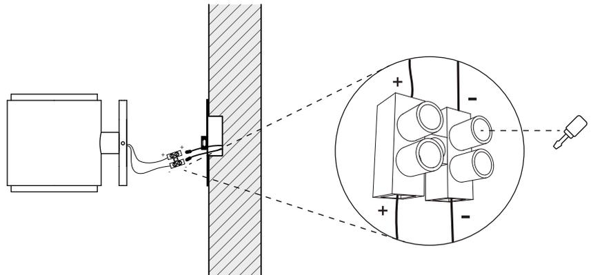
**4** Sujetar cuerpo a placa de acero.
