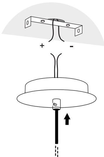
**3** Conexión de cables + con + y - con - a través del conector.
